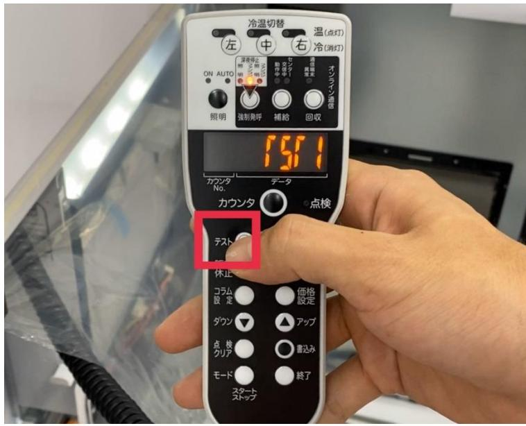
2. 続けてアップ・ダウントボタンのどちらかのボタンを押していくと、写真のように商品を排出したいコラム（今回の場合は〈CL 5〉）を選び、モードボタンを押してください。商品が出口から1本だけ排出されます。
